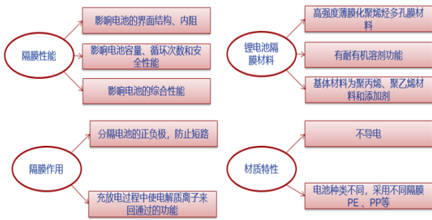
图 48: 锂电池材料中隔膜技术壁垒最高
