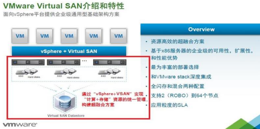
图 22 VMware 通过“vSphere+VSAN”实现超融合方案
