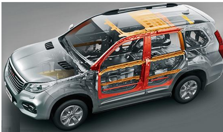
图 4：哈弗车身采用环状包络骨架、冲击能量吸收结构、高刚度设计
