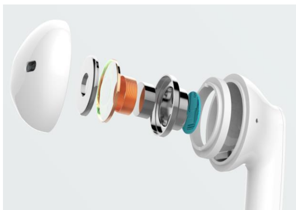
图 47: 蓝牙耳机结构
