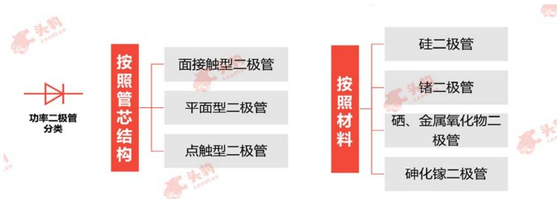
**检波二极管：**在叠加在高频载波上的低频信号检出的期间，检波二极管具有较高检波效率与良好的频率特性。锗材料点接触型工作频率可达 400MHz，正向压降小、结电容小、建波效率高、频率特性好，多用作检波二极管。
