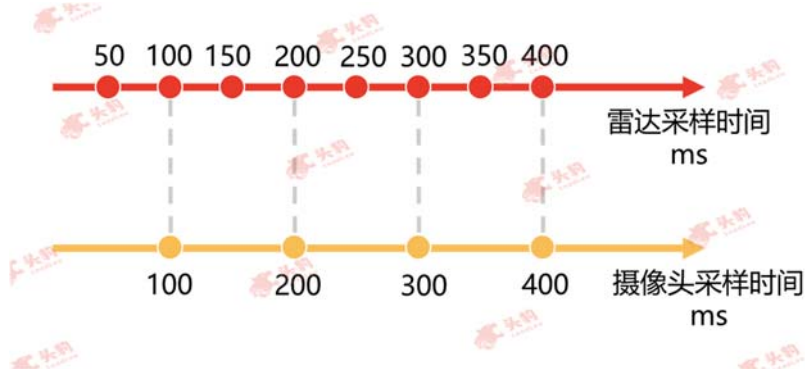
图 6-2 毫米波雷达与摄像头在时间上的融合
