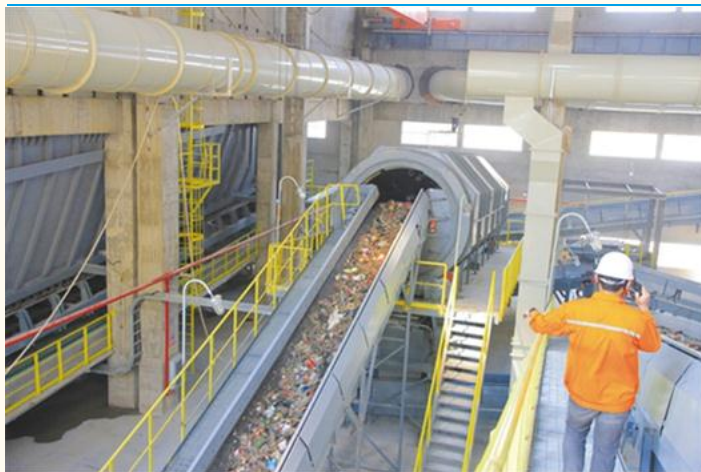
图表 50：正在处置城市垃圾的水泥熟料生产线
