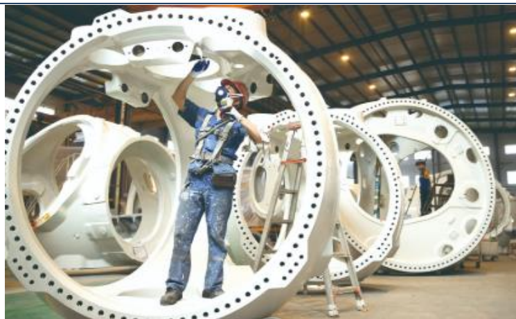
图4：风机轮毂部件涂装漆面精修工序
