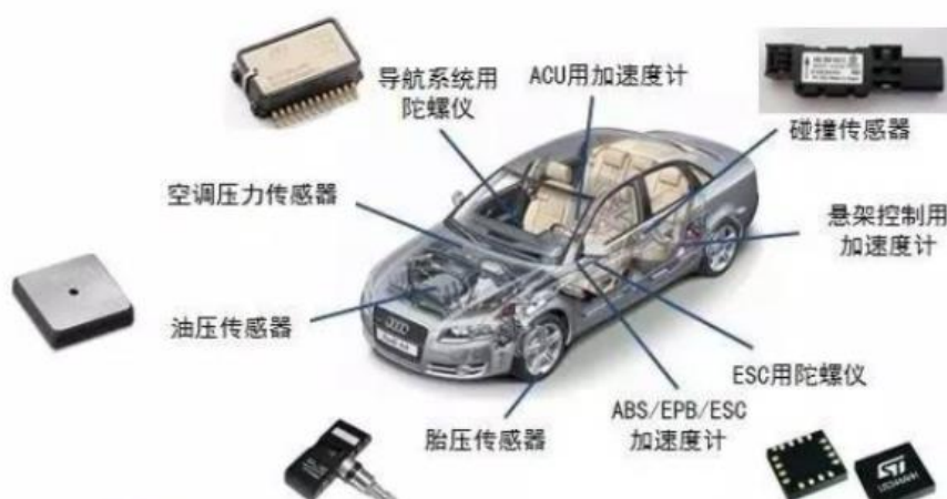
图表 20 汽车电子 MEMS 部分车体使用情景
