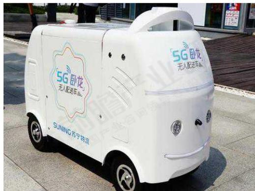
菜鸟无人车定位在末端配送，载重100kg，车速最高控制在15km/小时。当无人车运行过程中检测到进入行人或车辆较多的复杂路段时，会自动降速到10km/小时，且无人车红外探测距离有100米，能够预测移动物体的行动轨迹。
