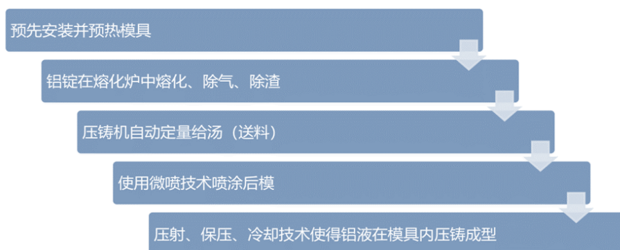
图14：压铸工艺流程
