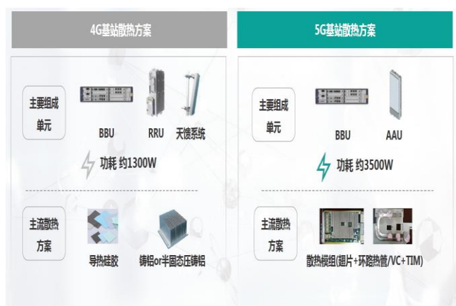
图表 17 5G 基站散热方案升级
