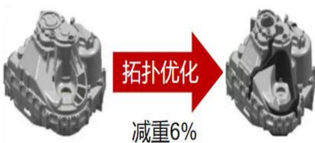
图 32 汽车变速器的拓扑优化效果
