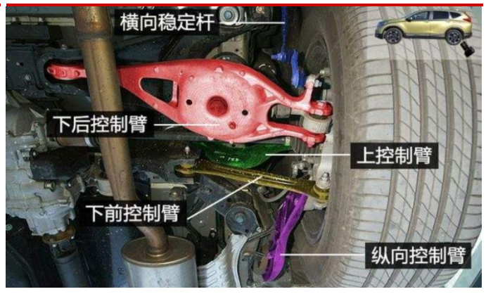
图 65 本田 CR-V 后悬架控制臂
