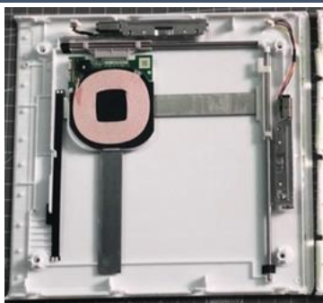
图 29：小米智能追踪无线充电器线圈移动方案
