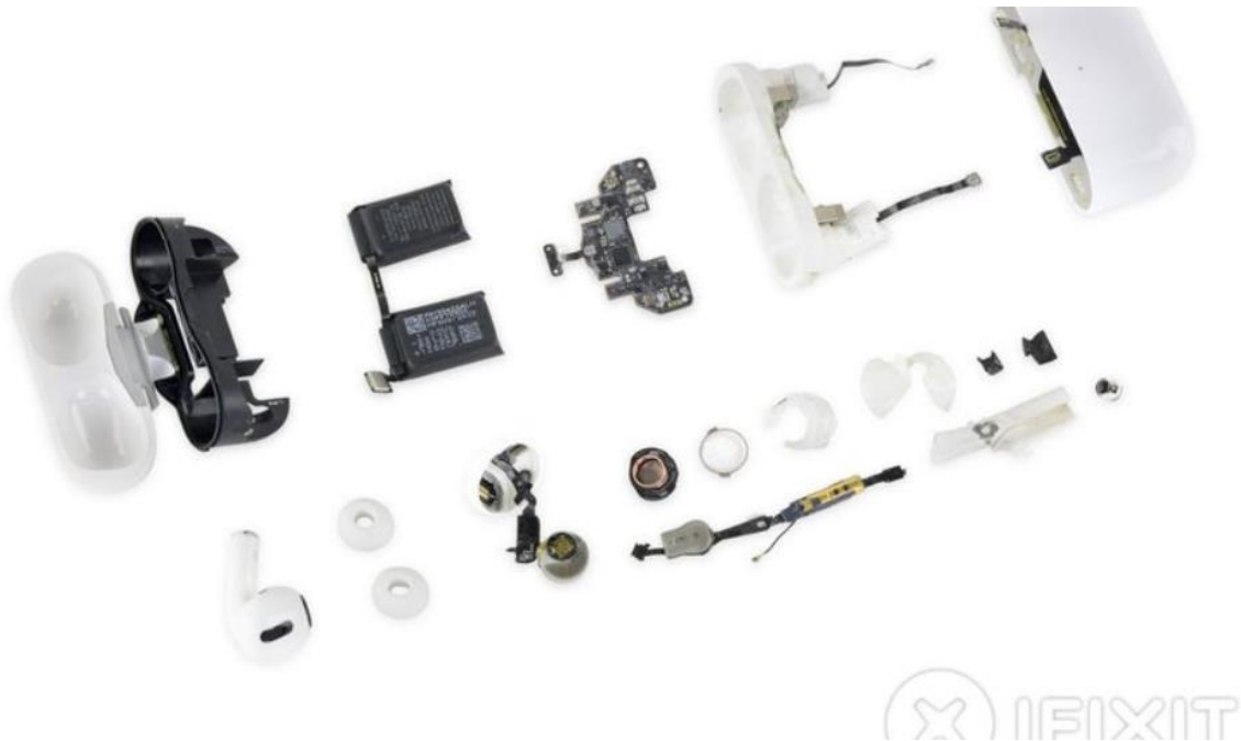
图 44：AirPods Pro 拆解图
