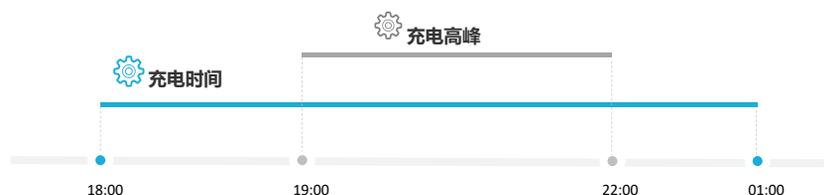
而居民生活用电在夜间有8个小时左右的低谷期，负荷率仅为10%-20%，若充分利用80%的低谷容量空间，现有配电网无需改造即可实现社区全部车辆充电。这类充电场所的充电机的启停控制可通过有线或无线通信的方式由集中的控制系统远程操控，从而实现电动汽车的有序充电。
