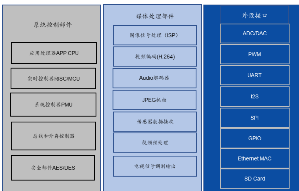
图 15：典型的 IPC SoC 芯片架构图
