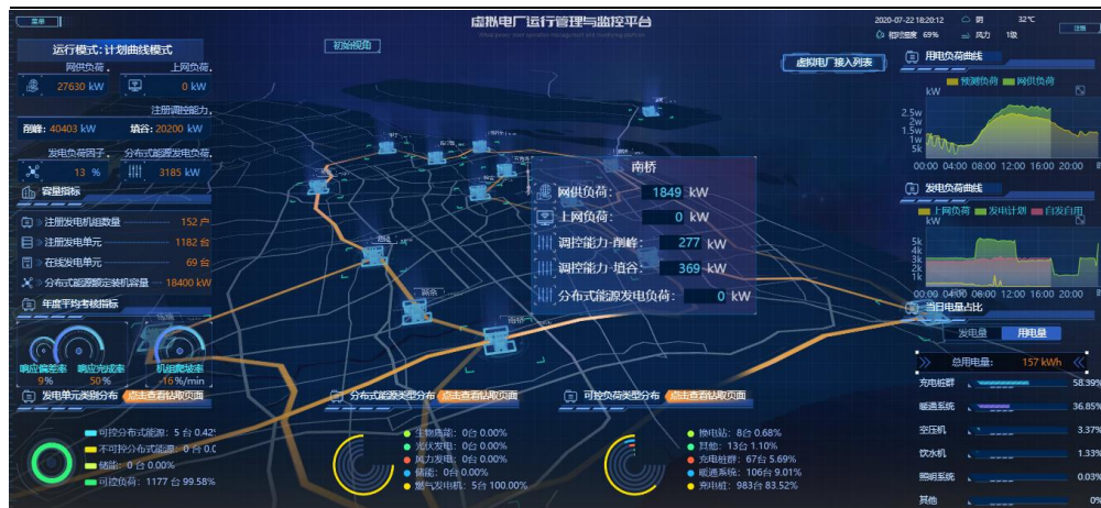
图17: 虚拟电厂运行管理和监控平台
