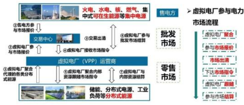
图18: 虚拟电厂参与电力市场流程
