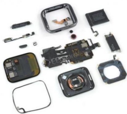
图 23: Apple Watch Series4 单机 FPC 用量 13 条
