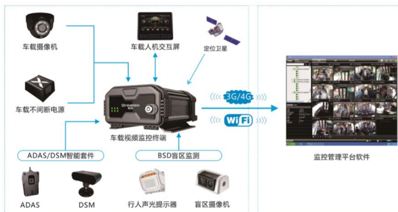
图表 5 通用智能视频监控产品系统架构
