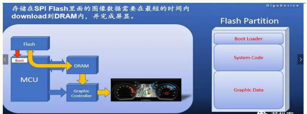
图表 24：NOR Flash 车载应用系统框图
