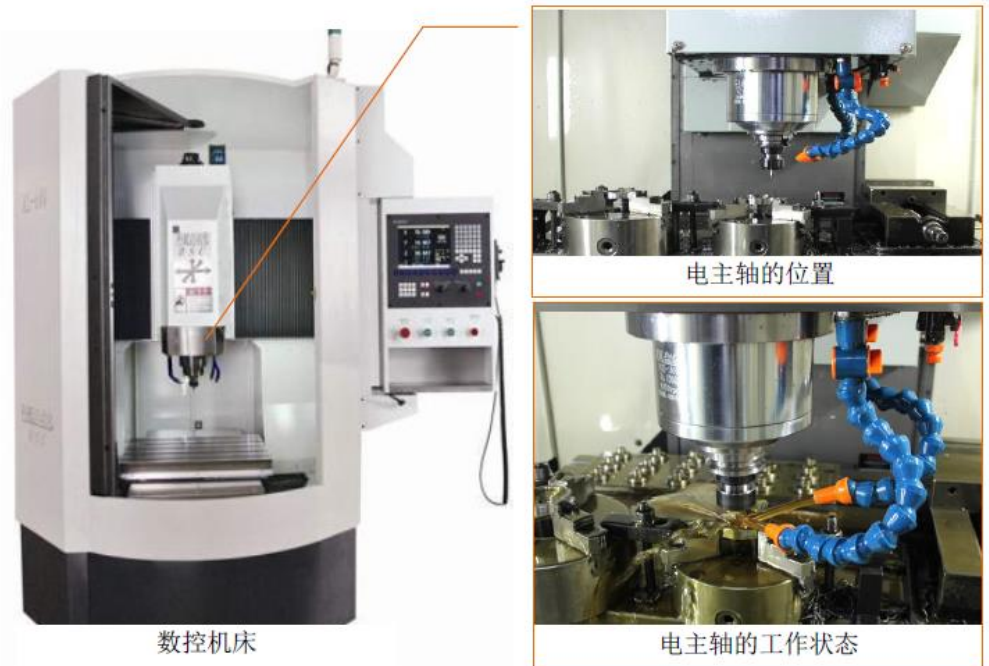
图18：电主轴在数控机床中的位置与工作状态
