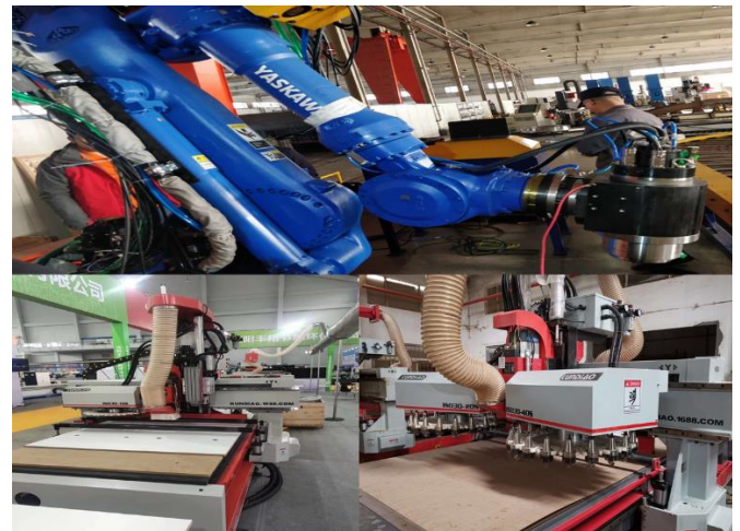
图32：电主轴应用于机器人打磨及木工机械
