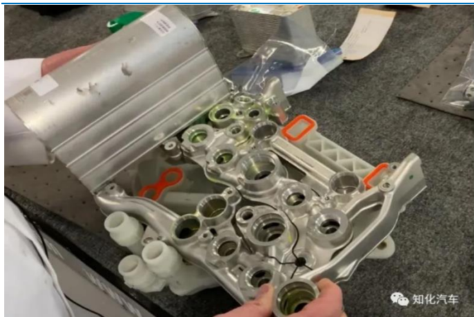
图 20: 汇流板与制冷剂分配板装配
