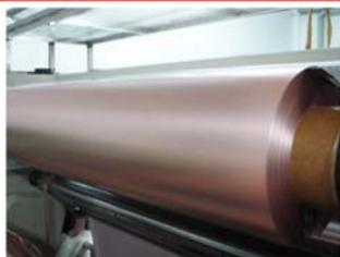
5 $\mu$ m铜箔面密度：43-46g/m<sup>2</sup>      5 $\mu$ m铜箔抗拉强度： $\geq 320$ N/mm<sup>2</sup>
