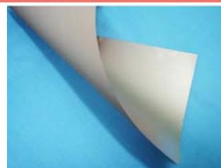
12 $\mu$ m铜箔面密度：93-97g/m<sup>2</sup>      12 $\mu$ m铜箔抗拉强度：
