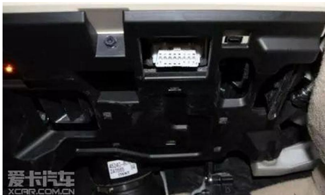
图 28：车内 OBD 接口示意
