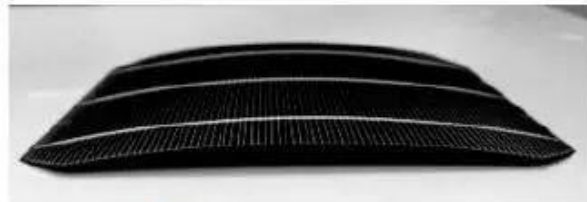
(a) 厚度 110 μm PERC 电池
