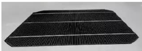
(b) 厚度 150 μm PERC 电池
