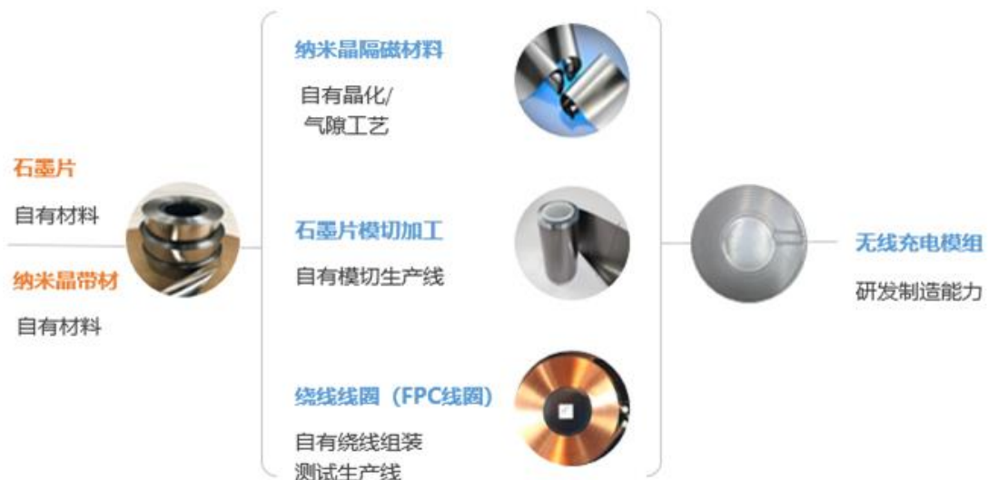
图 20: 手机无线充电模组制作流程
