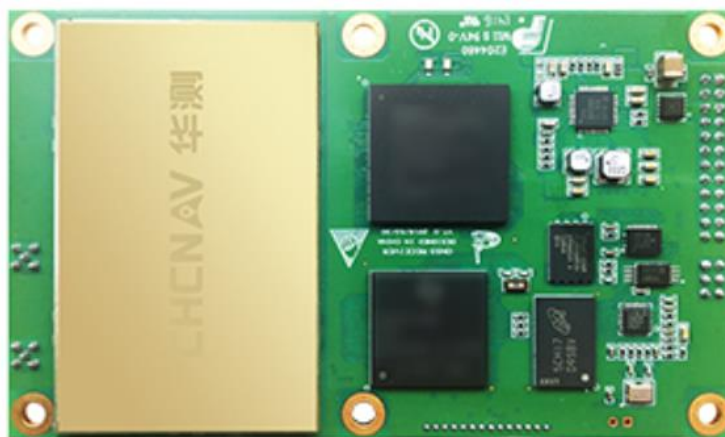
图24: OEM 板卡用于信息的解调和解算
