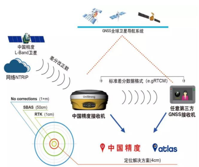
图37: “中国精度”星基增强系统提高定位精度
