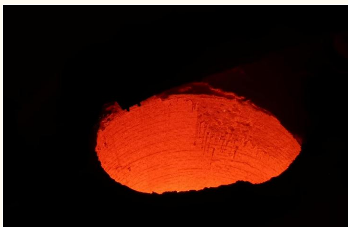
图表 23：不同位置的耐材与钢水的接触面积存在差异
