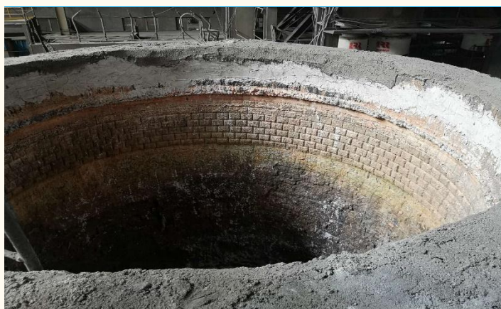
图表 7：被钢水侵蚀后的耐火砖
