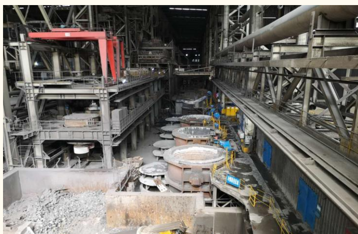
图表 22：正在现场进行更换耐材的钢包
