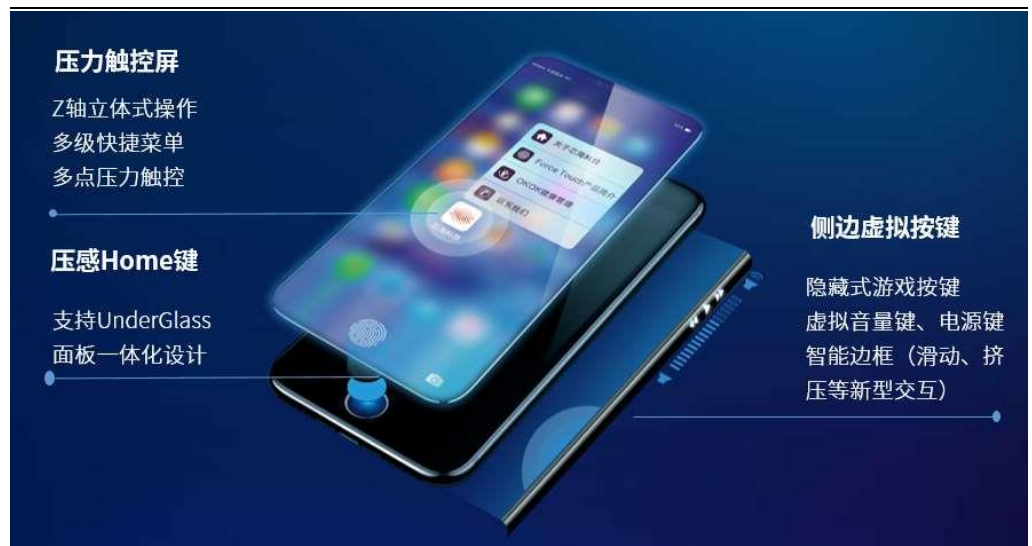
图19: 压力触控芯片用于压感 Home 键、压力触控屏和测边虚拟按键
