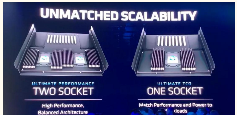
图表 12：一台服务器—2x AMD CPU, 8x 内存通道，每通道二模组
