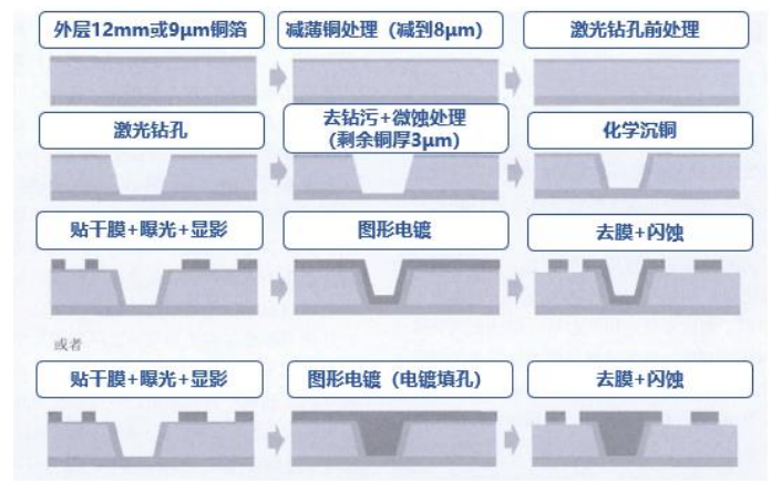
图18: MSAP 半加成法工艺复杂
