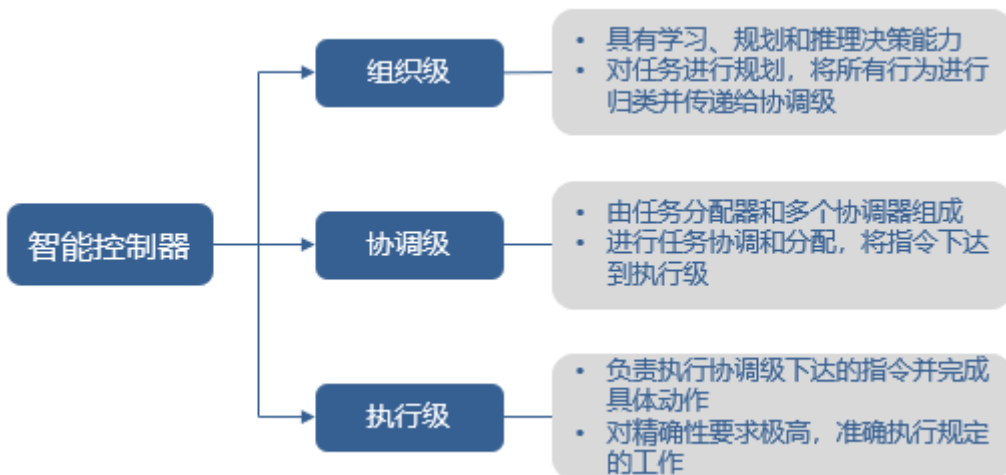
图 2-1 智能控制器基本结构概述
