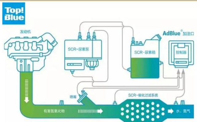
图 39：车用尿素(AdBlue)结合 SCR 系统可大幅降低 NOx 排放
