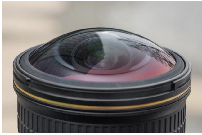
图19: 鱼镜头的前镜片直径很短且呈抛物状向前凸出
