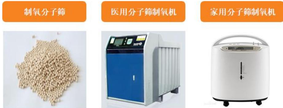
用分子筛物理吸附和解吸技术。加压时将空气中氮气吸附，未被吸收的氧气被收集起来，经过净化处理后即成为高纯度的氧气；减压时将所吸附的氮气排放回环境空气中，下一次加压时又可以吸附氮气并制取氧气，整个过程为周期性地动态循环过程。
