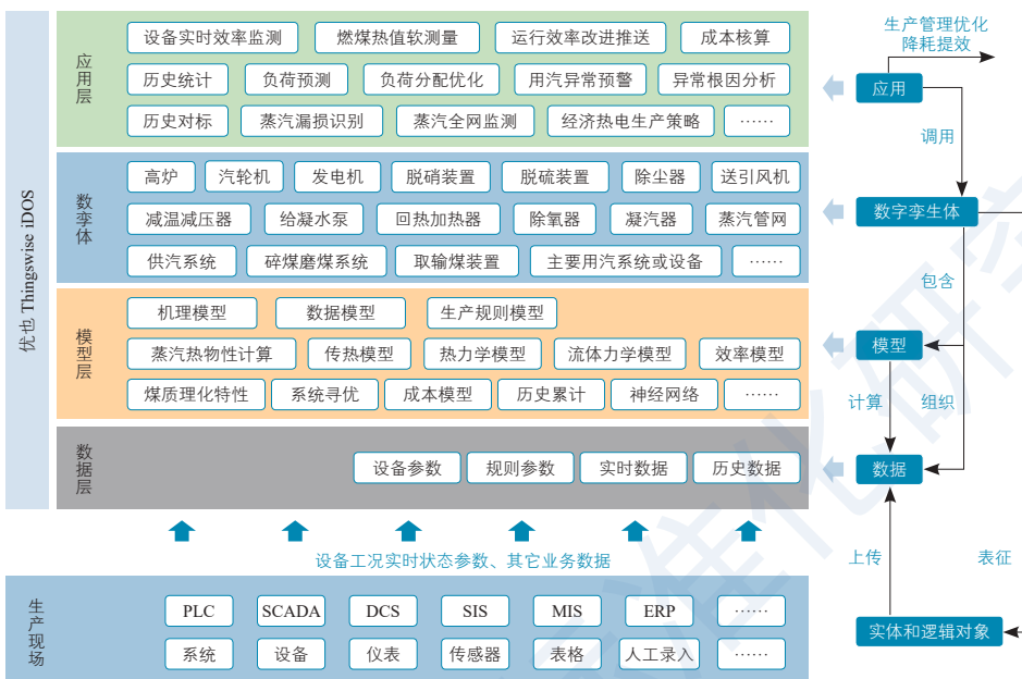
图 70 智能热电管理系统功能架构图
