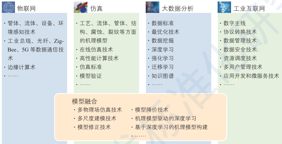
图 95 管道数字孪生构建技术
