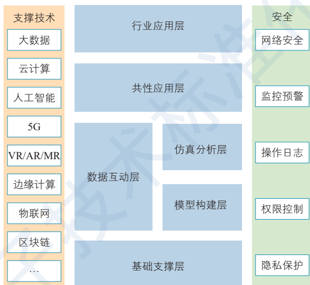
图 28 数字孪生整体分层架构
