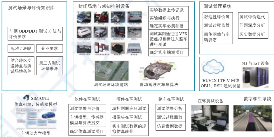
图 88 数字孪生自动驾驶测试系统的主要组成部分
