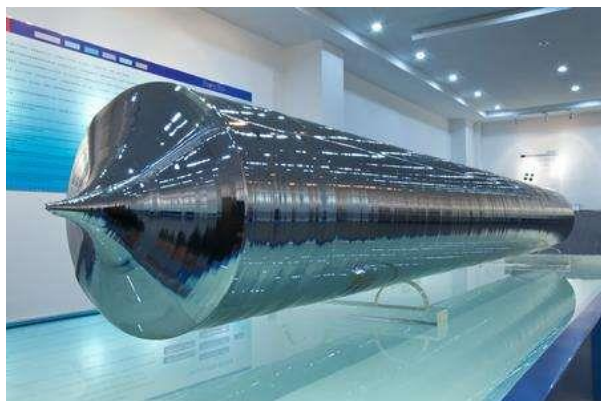
图 21: 晶棒总长度越长，头/尾椎长度相对占比越小
