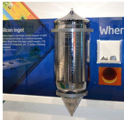
图 22: 晶棒总长度越短，头/尾椎长度相对占比越大
