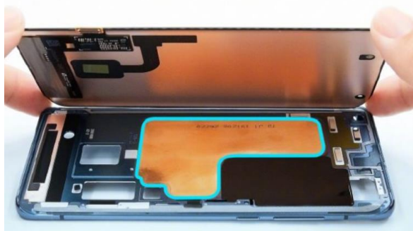
图表 31：小米 10 使用大面积均热板
