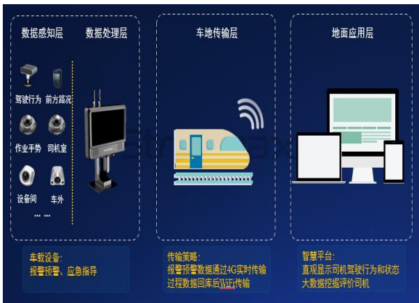
图表 49：公司地铁安全驾驶辅助系统框架图
