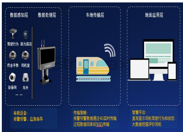
图表 49：公司机车驾驶智能辅助系统框架图
