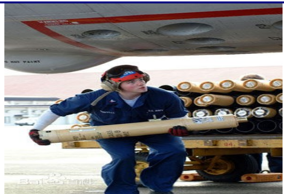
图 29 美军反潜巡逻机装载的声呐浮标
