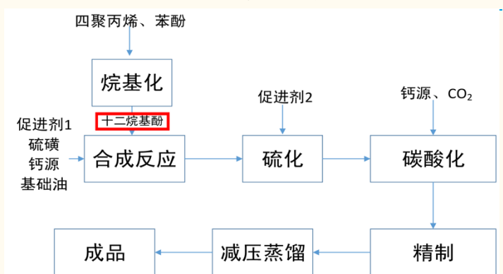
图表 32：硫化烷基酚钙类清净剂生产过程
