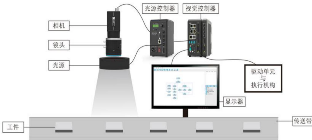
图 1 典型的机器视觉系统构造
