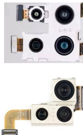
图表 161: 华为 Mate 30 Pro (左) 及 Mate20 Pro (右) 摄像模组大小对比
