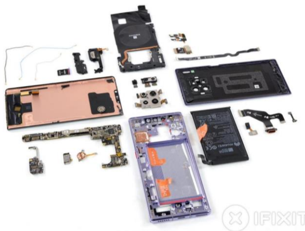
图表 163: 华为 Mate 30 Pro 器件拆解图
