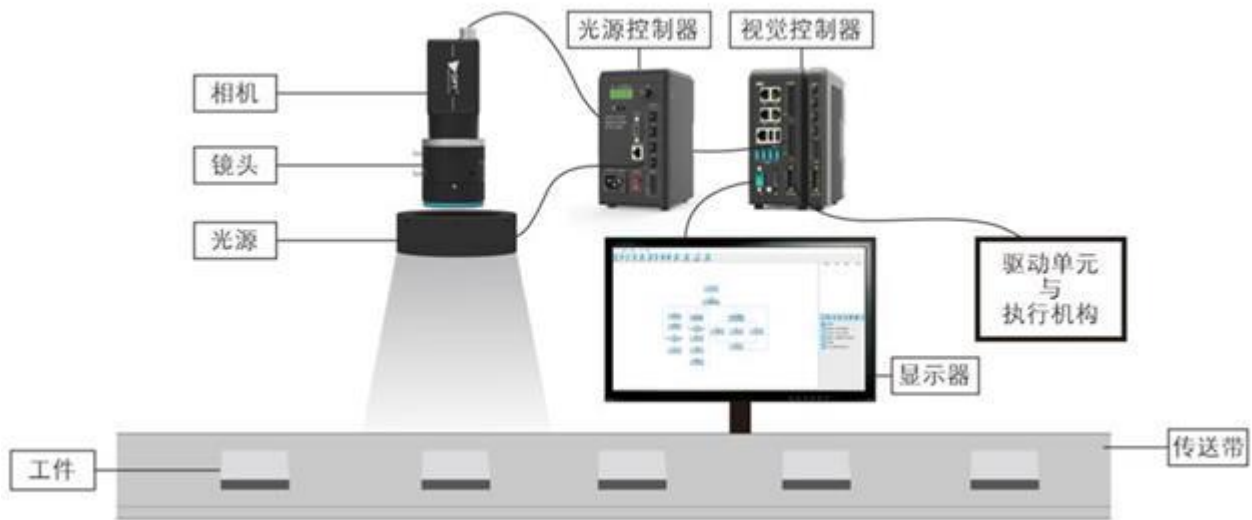
图 14 典型的机器视觉系统一般包括光源及光源控制器、镜头、相机、视觉控制系统
