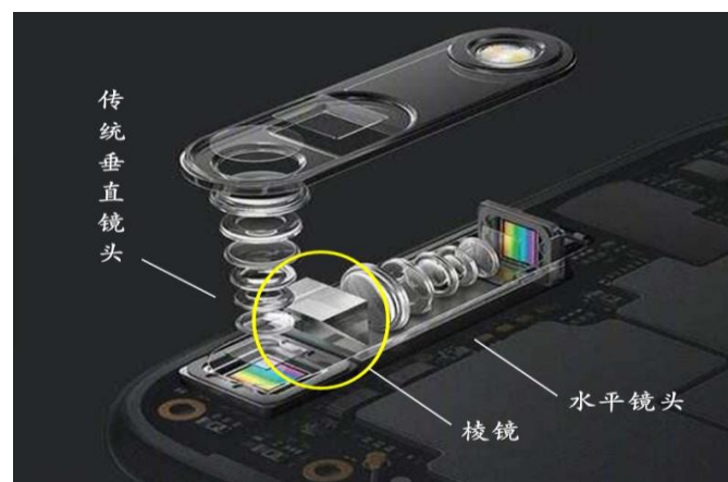
图表 31 潜望式模组示意图
