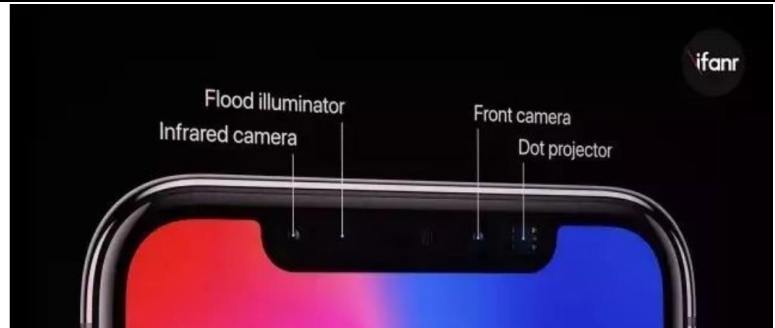
图表 36 iPhone X 结构光模组示意图
