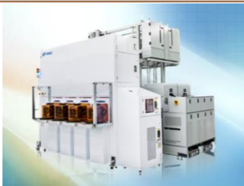
图 81：中微公司 Primo HD-RIE 系列 CCP 刻蚀机
