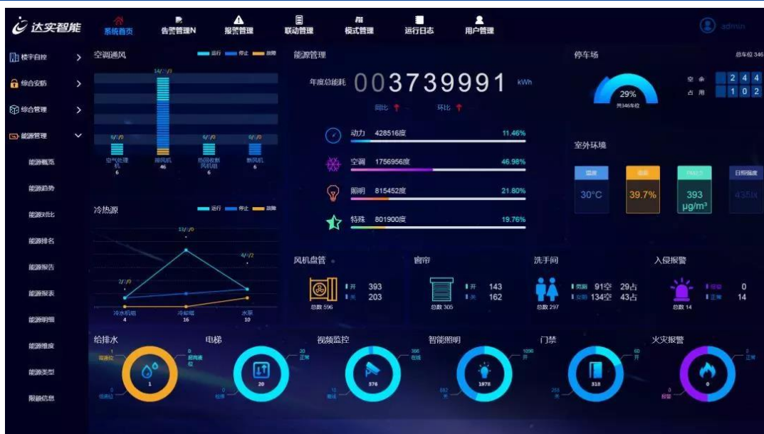
图表 18: 达实智能 IBMS 建筑能耗管理系统
