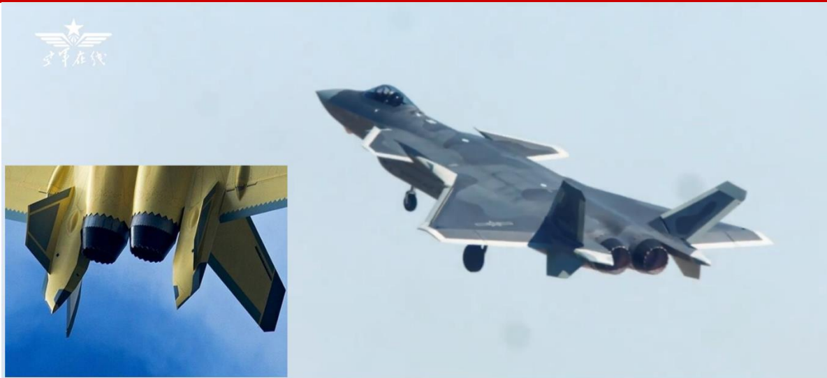
图 1 歼 20 换装锯齿状 WS-10 发动机
