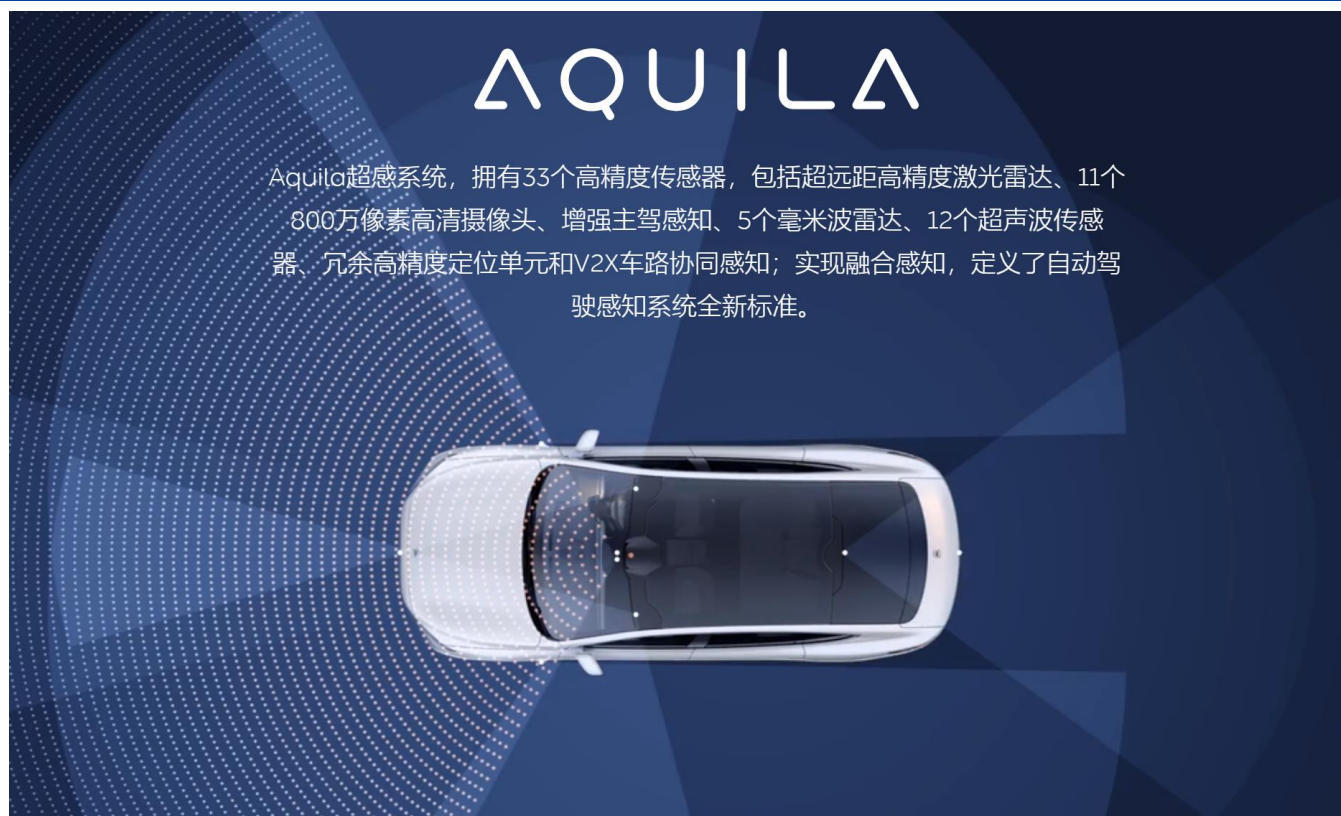
图表 15: 蔚来 Aquila 超感系统配置 11 个 800 万像素高清摄像头
